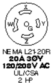
Imagen 13. Contacto L2120R, G: tierra física, W: neutro, X/Y/Z: fases. 1
